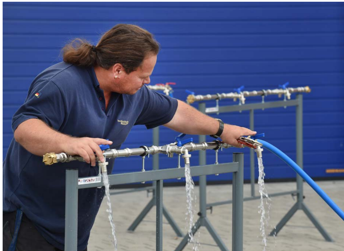
Im THW entstehen immer wieder Lösungen der „Marke Ehrenamt“, wie beispielsweise bei dieser Wasserentnahmestelle. Damit solche innovativen Bauanleitungen erhalten bleiben, werden sie künftig in ILIAS hinterlegt und zusammengeführt.
