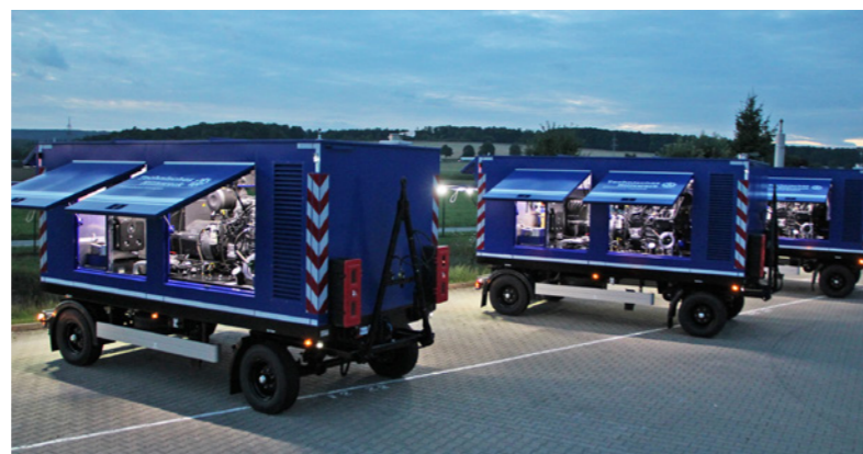
Die neuen Stromerzeuger sind speziell nach den hohen Anforderungen des THW gebaut und können unterschiedliche Betriebsarten fahren. Foto: AVS Aggregatebau GmbH
