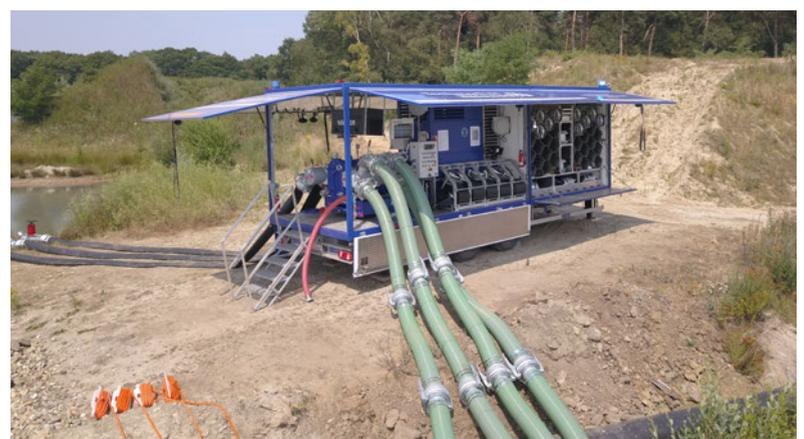
Die neue THW-Hochleistungspumpe fördert 25 000 Liter pro Minute und Einsatzkräfte fluteten mit ihr bereits ein unterirdisches, brennendes Kohlestaubbecken. Foto: THW/Thorben Schulz
