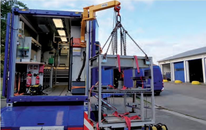
Mit dem Werkstattcontainer können THW-Einsatzkräfte ihr Gerät künftig quasi überall reparieren und instand setzen. Foto: THW
