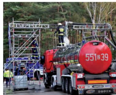
Mithilfe eines Einsatzgerüsts (EGS) können sogar große Tanksattelzüge mit Löschwasser befüllt werden. Foto: THW/Mediateam Nord
